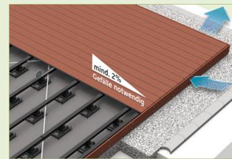
Mit Nutleiste/Fugenprofil P5
