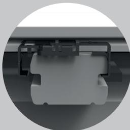
Rastklammer- Rand stirnseitig auf den Konstruktionsbalken schieben.
